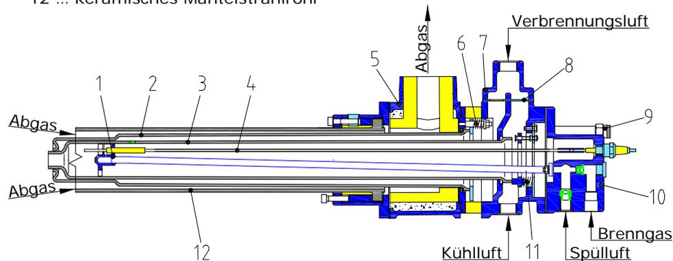
Der **Brenner** besteht aus einem dreiteiligen Brennerkopf, einem Rekuperator sowie aus den innen liegenden Bauteilen Brennrohr, Gaslanze und Elektrode.
