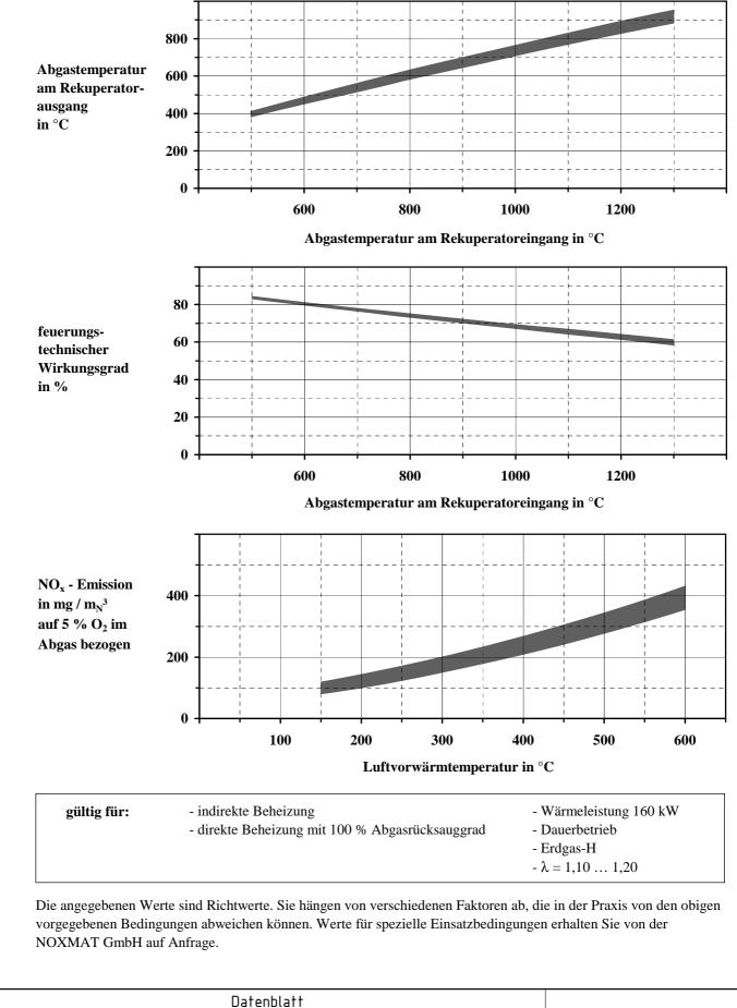
Rekuperator – Hochgeschwindigkeitsbrenner
